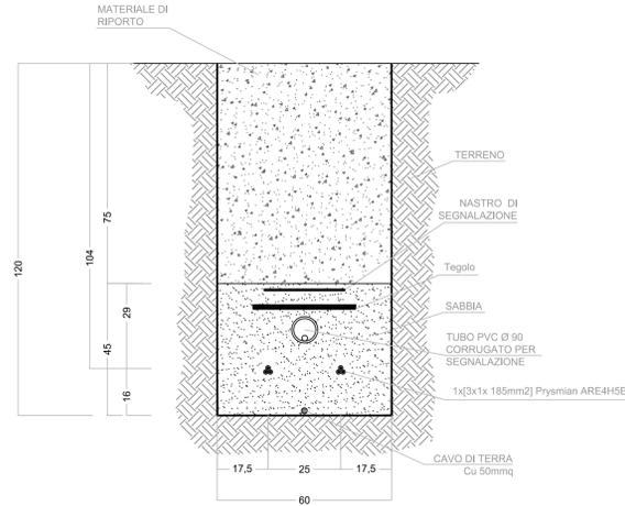
**SEZIONE TIPO SINGOLA TERNA
