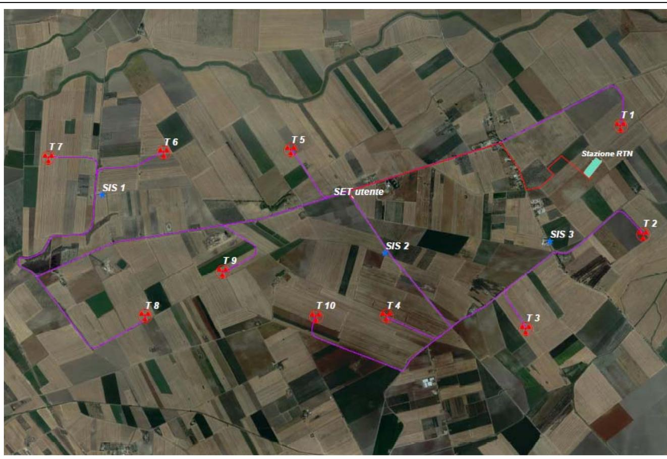
Indagine geofisica combinata di sismica a rifrazione e Masw
