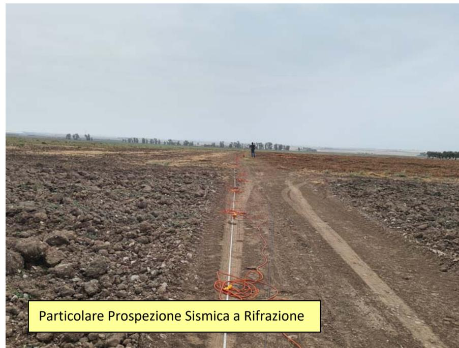
Particolare Prospezione Sismica a Rifrazione
