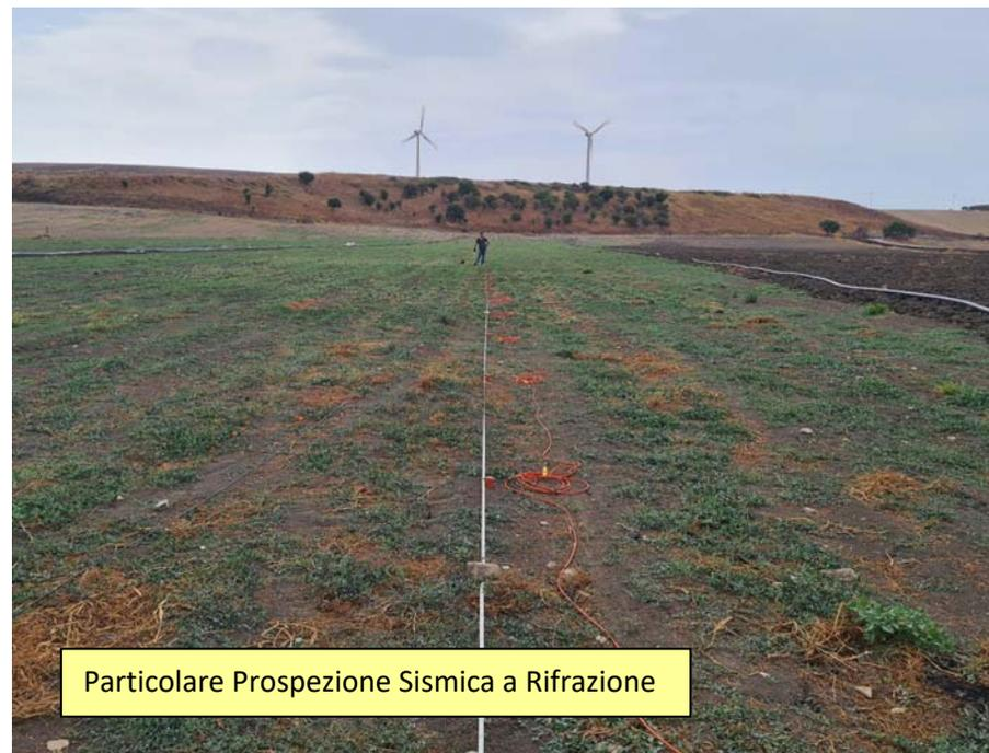
Particolare Prospezione Sismica a Rifrazione
