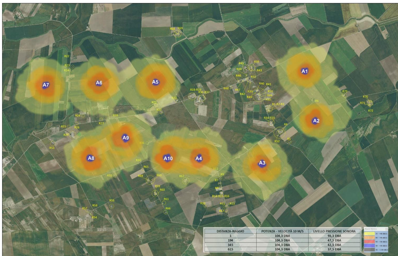
figura 32: Mappa curve Isolivello del rumore emesso dagli aerogeneratori di progetto espresso in Leq(A) nelle condizioni di massima emissione elaborata per velocità del vento di 10 m/s in vista estratta da Google Earth
