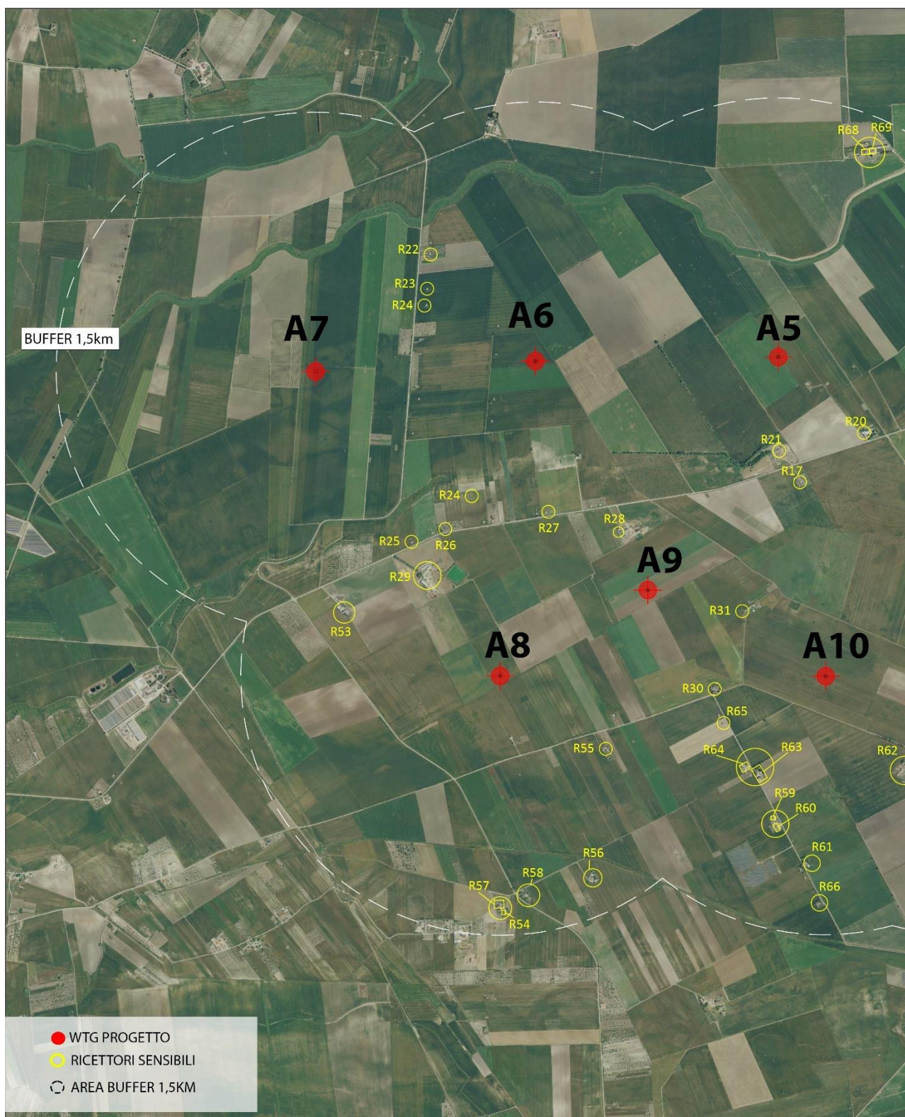
figura 15: Vista della porzione est del parco di Progetto con evidenza delle turbine A5, A6, A7, A8, A9, A10 e dei ricettori sensibili, indicati con etichetta "R", rientranti nel buffer di 1,5 km dalle torri.
