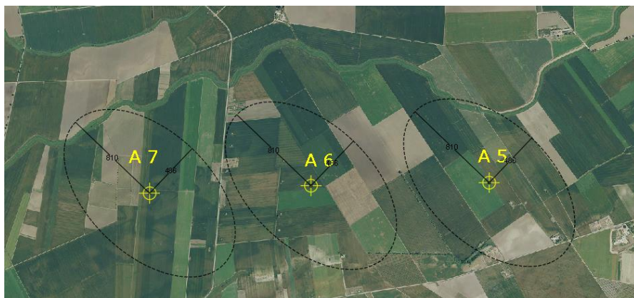
figura 7: schema del layout di progetto con indicazione delle interdistanze tra gli aerogeneratori.
