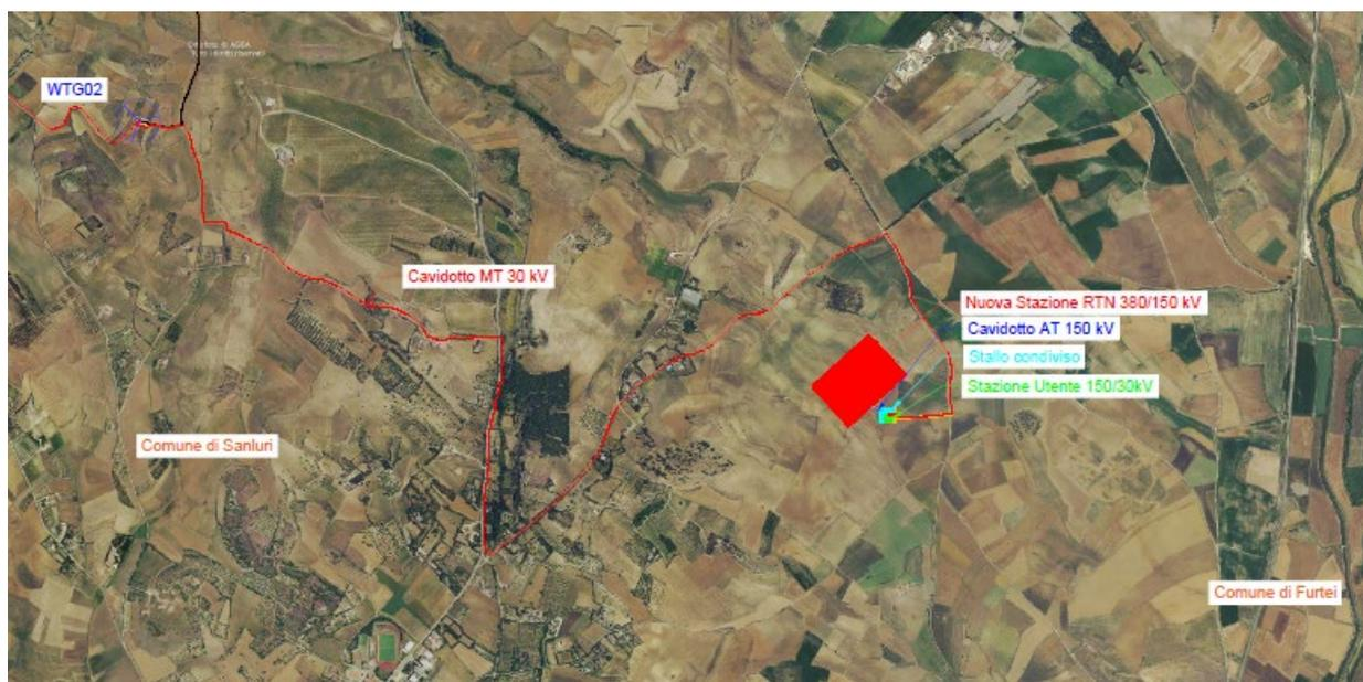
Figura 3-2 – Inquadramento generale da ortofoto – opere di connessione
