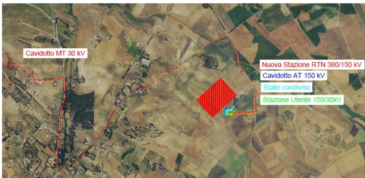
Figura 3-3 – Ubicazione opere di connessione su ortofoto
