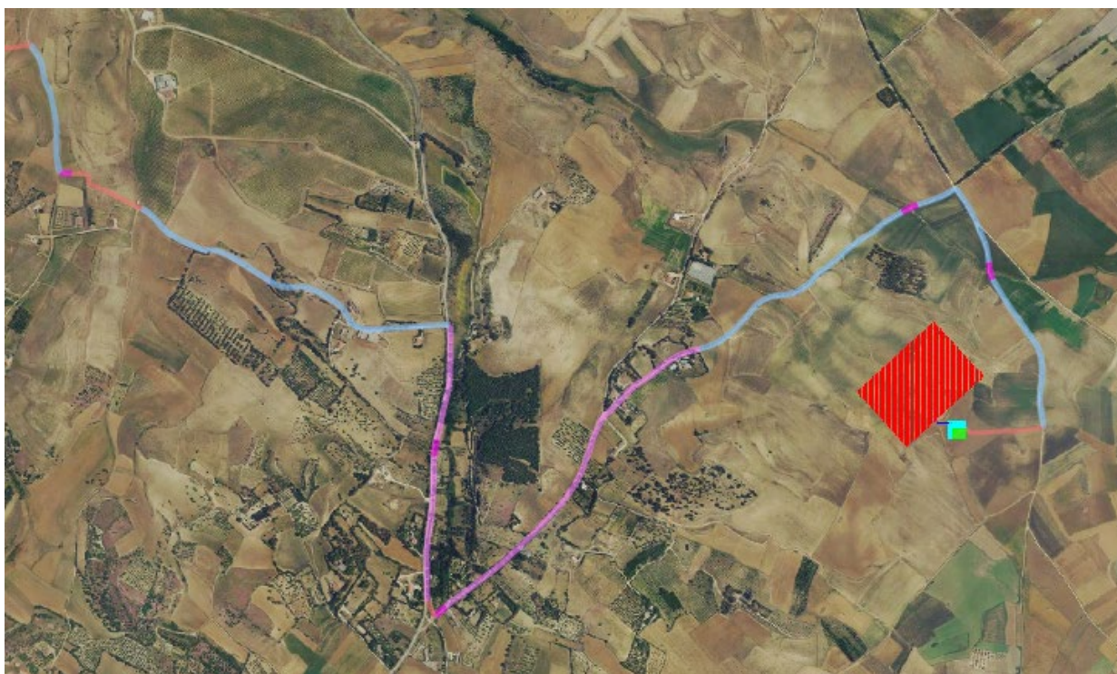
Figura 4-2 – Layout della rete MT su ortofoto – connessione alla SSE
