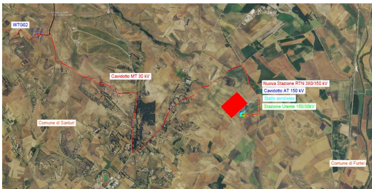
Figura 3-2 – Inquadramento generale da ortofoto – opere di connessione
