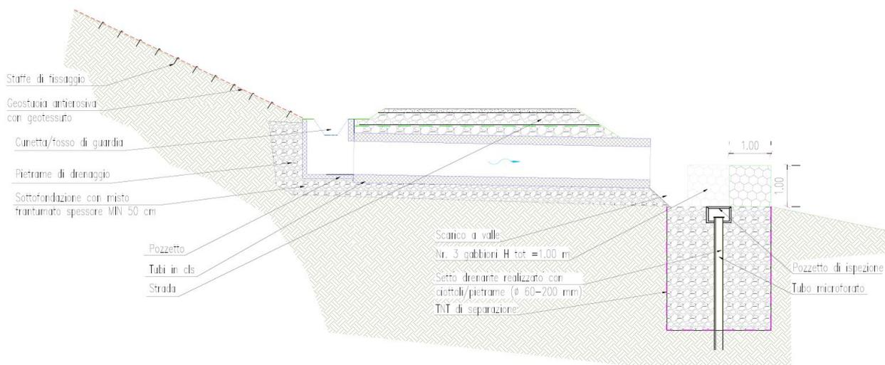
Figura 5-6 – Opere di regimentazione idraulica – setto drenante
