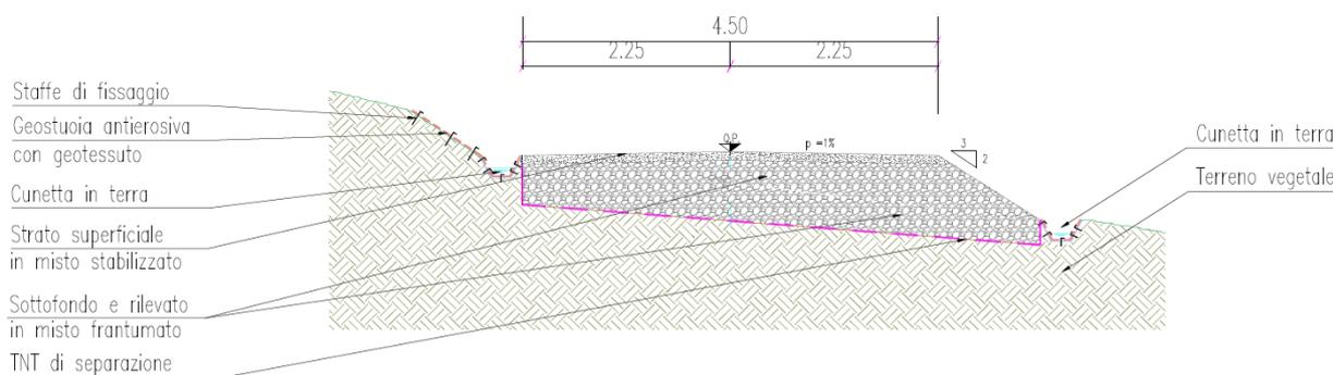
Figura 5-5 – Opere di regimentazione idraulica cunette in terra
