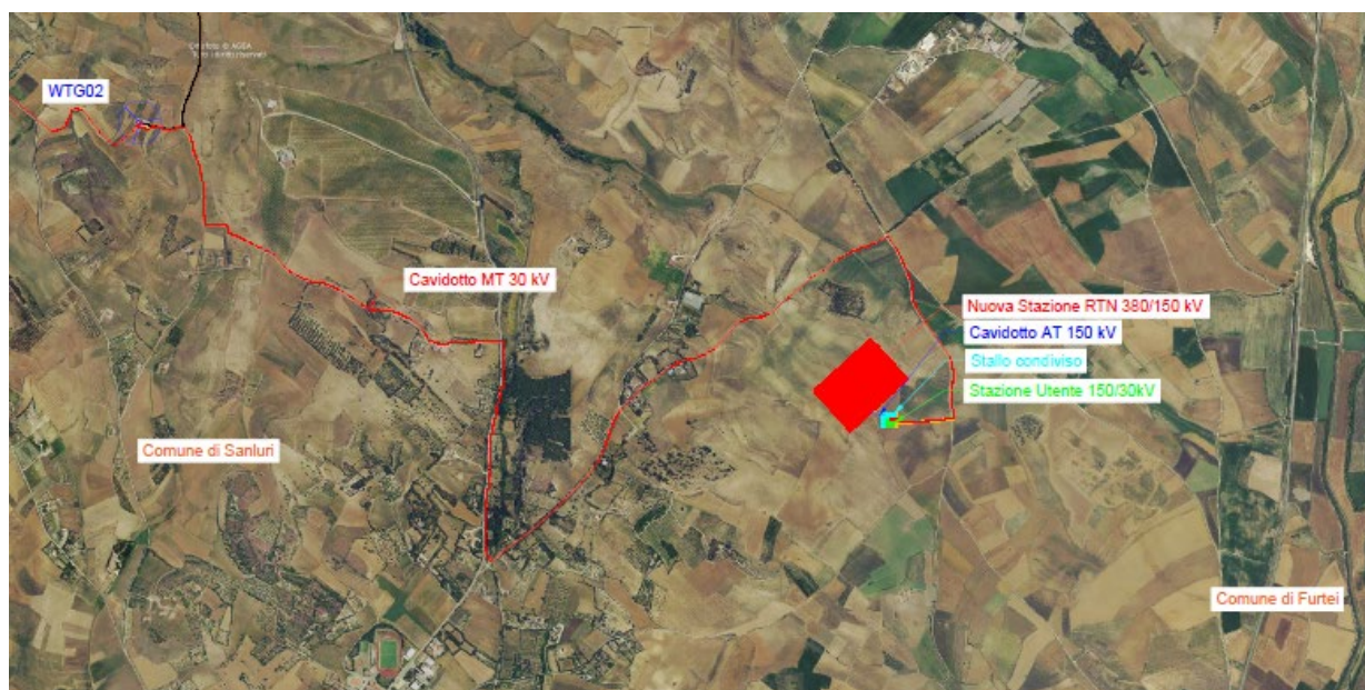
Figura 3-2 – Inquadramento generale da ortofoto – opere di connessione
