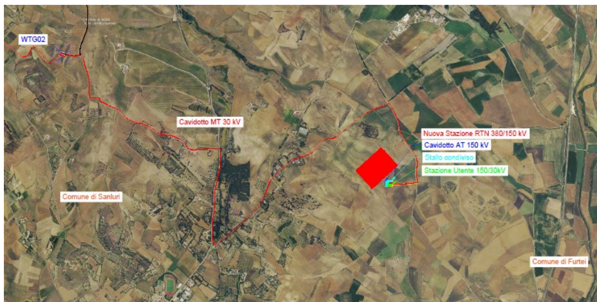
Figura 3-2 – Inquadramento generale da ortofoto – opere di connessione
