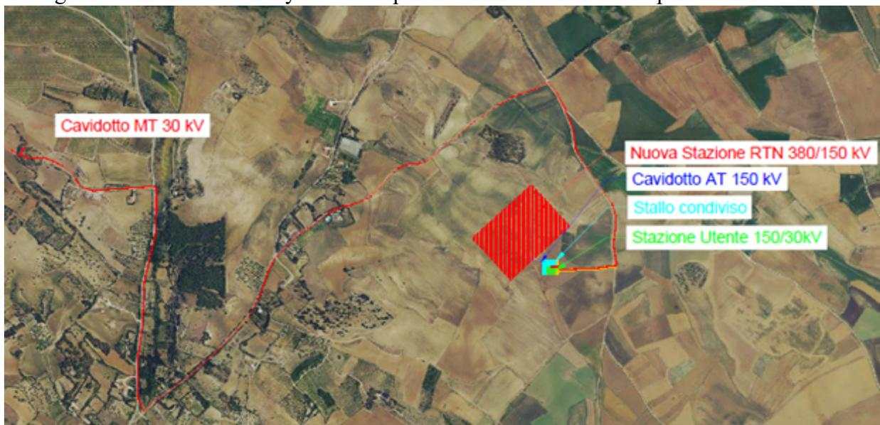
Fig. 4 – Ubicazione opere di connessione su ortofoto
