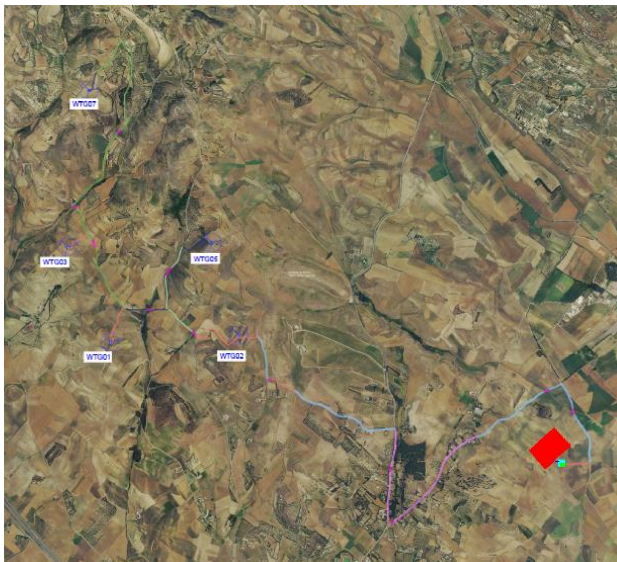
Figura 6-1 – Layout della rete MT su ortofoto
