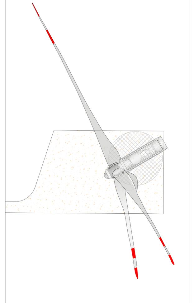
(\*) L'altezza massima al colmo dell'aerogeneratore è di 200 m, intendendo tale misura uguale alla somma dell'altezza della torre più l'altezza della pala. In base al fornitore/modello di macchina selezionato, l'altezza della torre e il diametro rotorico potranno variare rispettivamente entro questi limiti: max 126 m e max 170 m. In ogni caso la somma di torre più pala sarà tale da rispettare l'altezza massima di 200 m.
