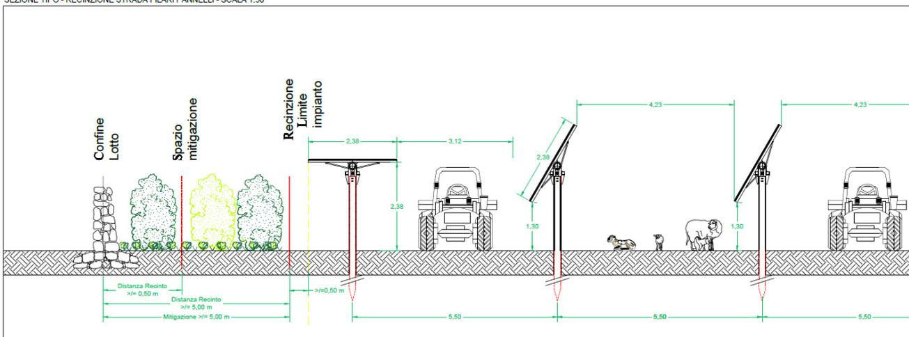
Figura 1 – Sezione tipo recinzione, strada, filari, pannelli
