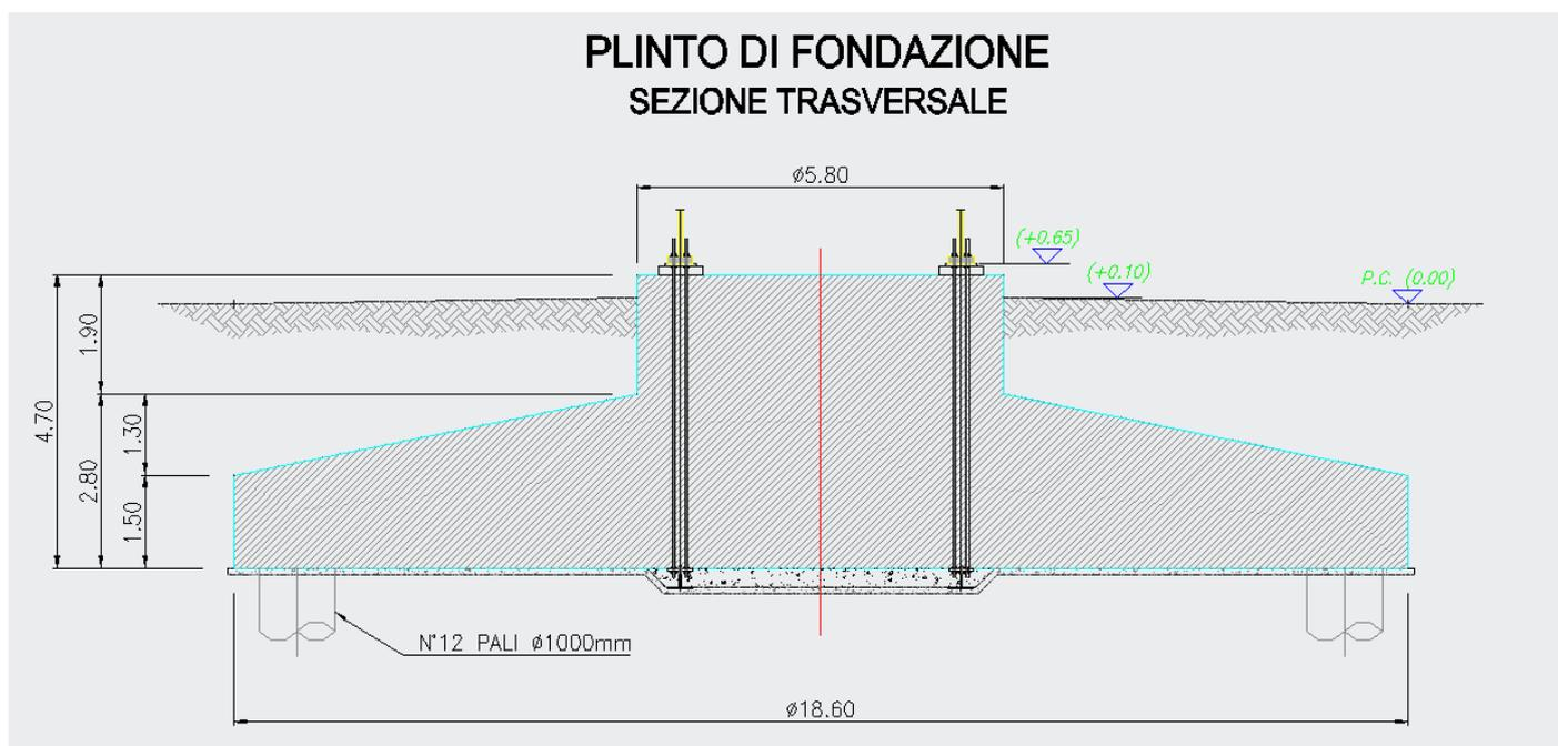
Figura d-1: Sezione tipo del plinto fondazione
