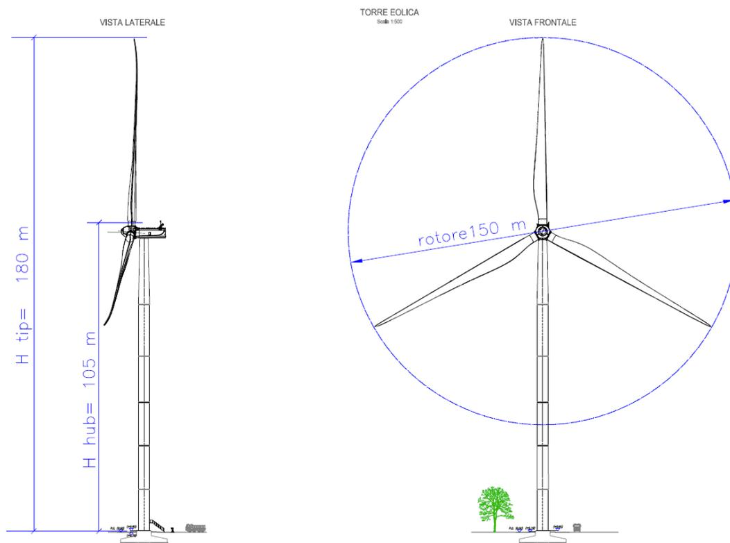
**Figura c-1: Struttura aerogeneratore**
