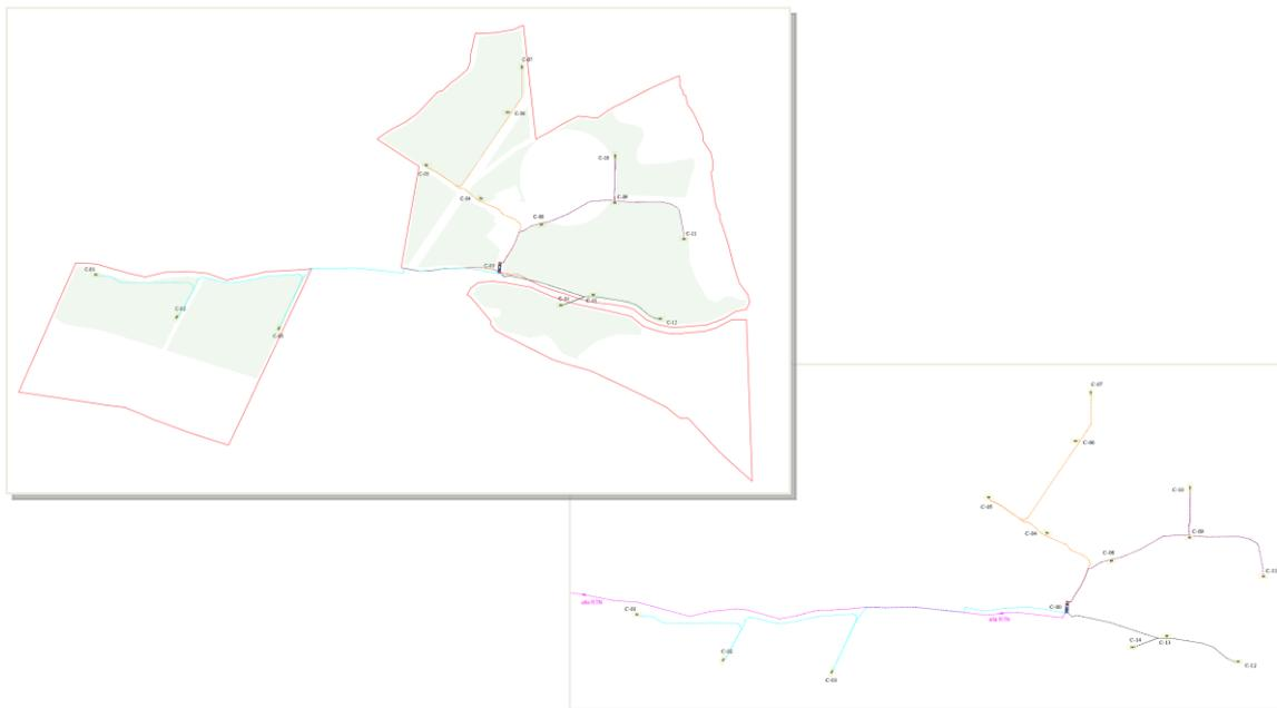
*Schema per il collegamento delle Cabine di Raccolta di Area e dei cavidotti interrati in AT a 36 kV per la loro connessione alla Cabina di Raccolta Generale.*
