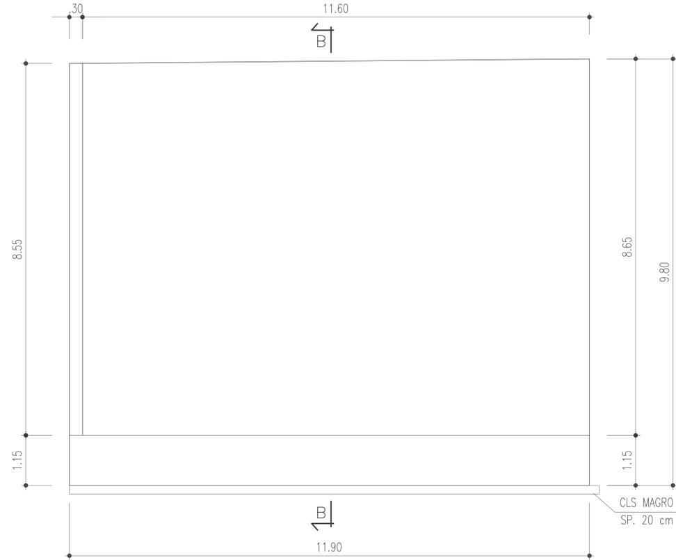
PIANTA MURO SPALLA 2 DX E SX
