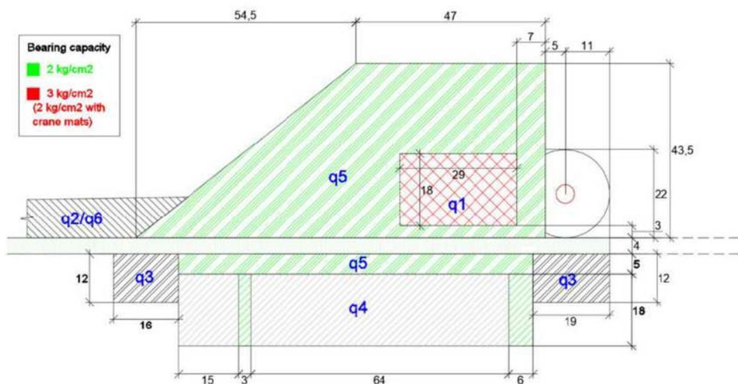
Fig.2-Piazzola di montaggio Aerogeneratore
