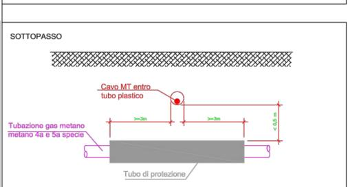
Nei parallellismi tra cavidotti MT o BT e tubazioni del gas metano non drenate a pressione nominale > 5 bar, la distanza minima tra le due superfici affacciate non deve essere inferiore alla profondità di interramento della condotta del gas, salvo l'impiego di diaframmi continui di separazione.
