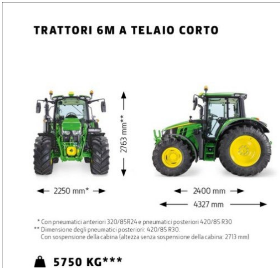
Figura 16 – Specifiche tecniche del trattore 6M a telaio corto
