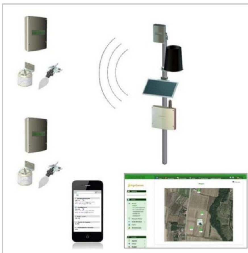
Figura 10 – Stazione principale e sensori meteo climatici.
