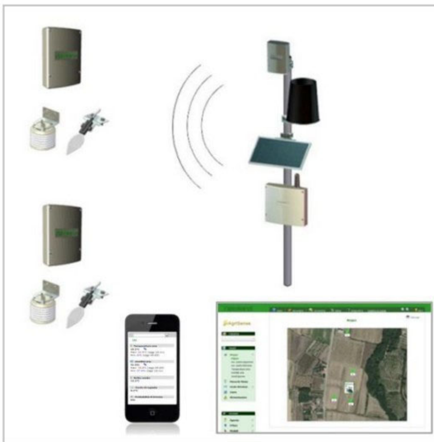
Figura 18 – Stazione principale e sensori meteo climatici.
