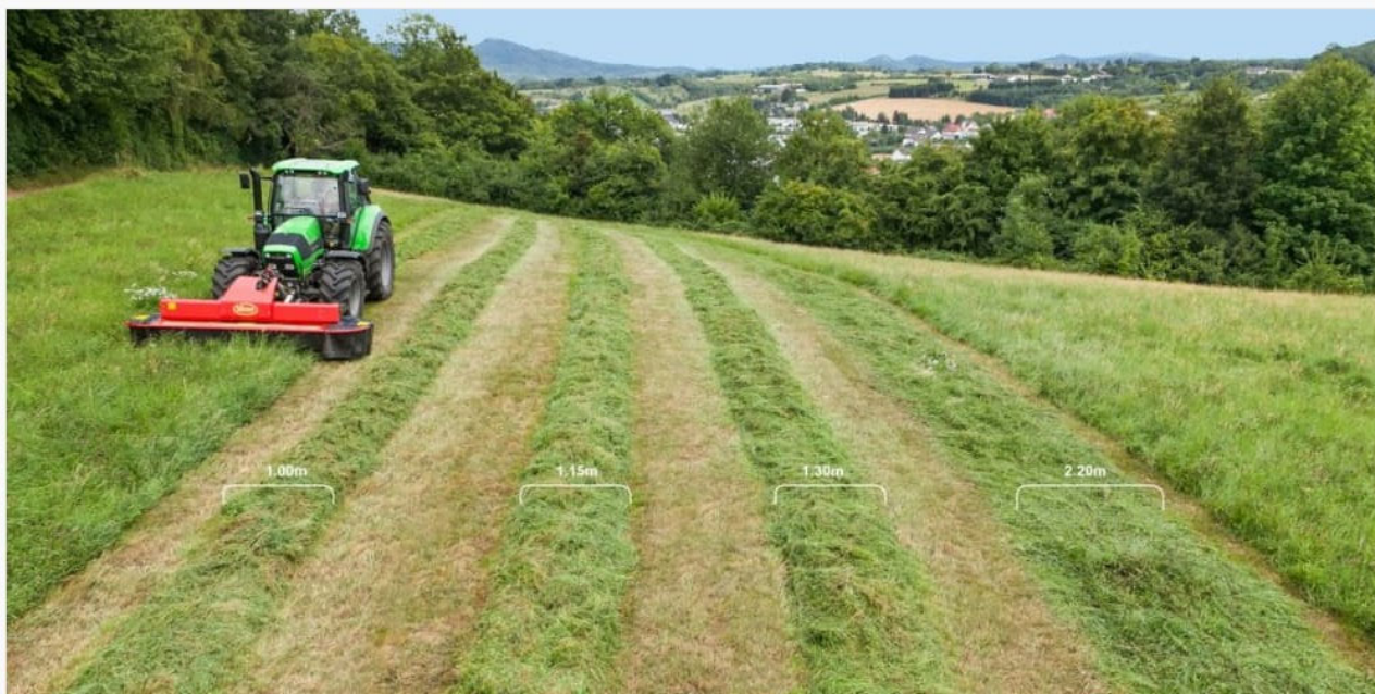
Figura 17 – Immagine della falciatrice anteriore e larghezze delle andane realizzabili
