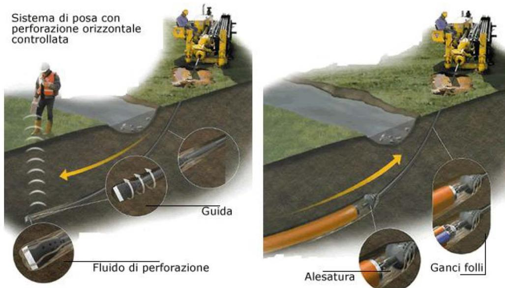
*Figura 11 - Posa in opera tubazione per alloggiamento cavi*
