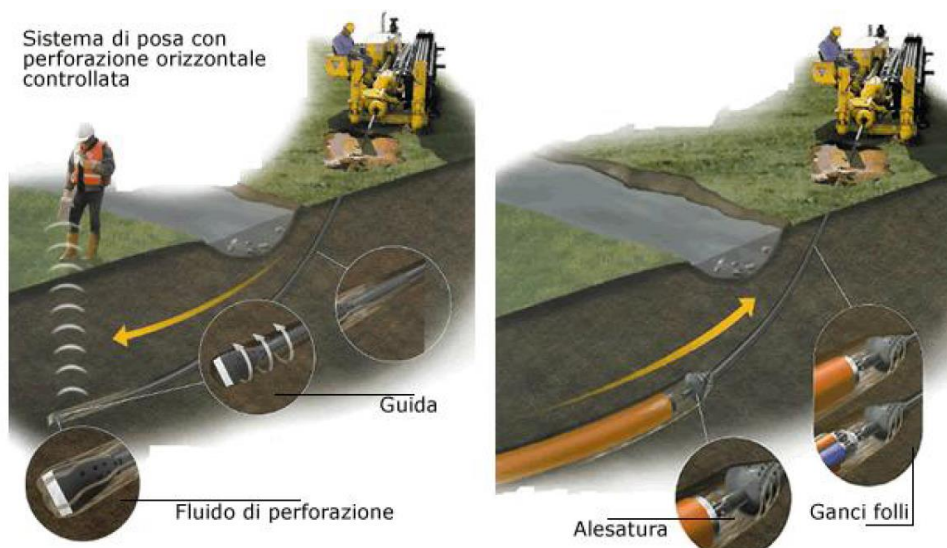
Figura 22 - Posa in opera tubazione per alloggiamento cavi
