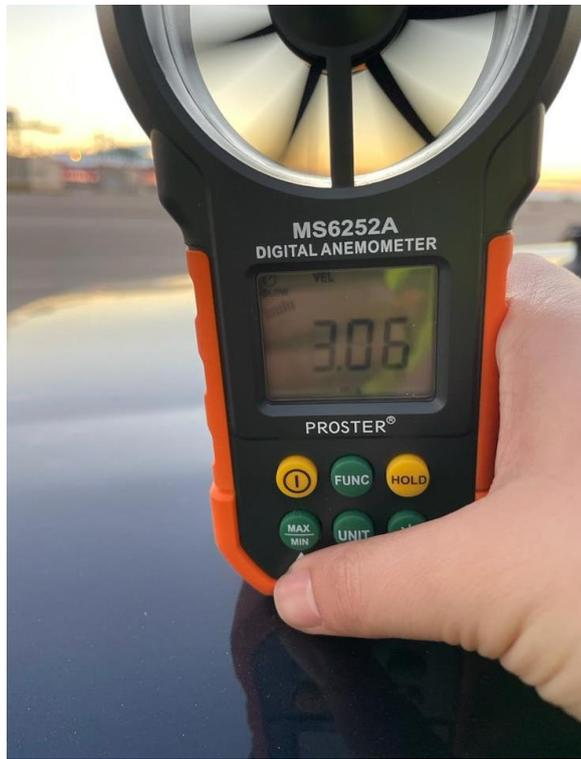
Foto 3 – anemometro per verifica velocità vento
