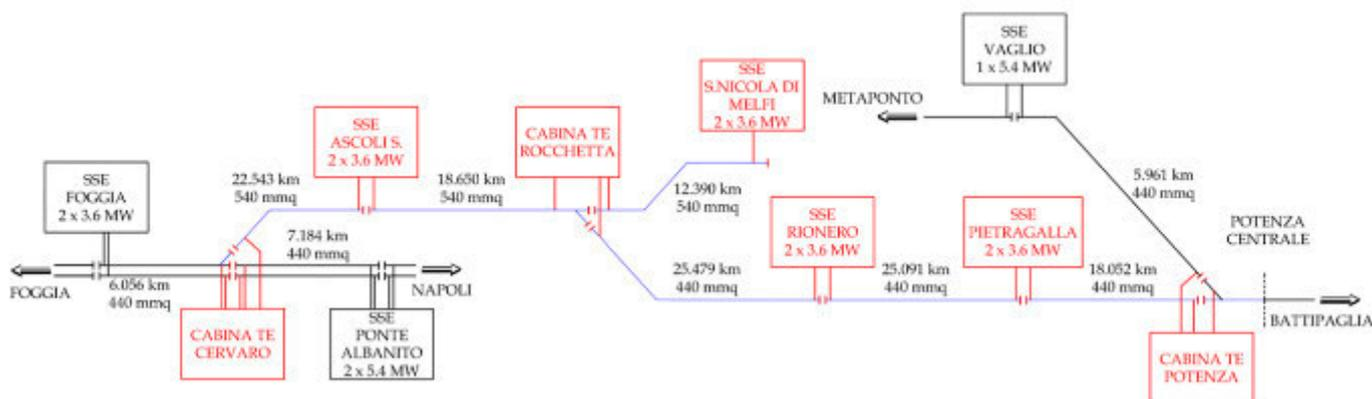
Figura 2 – schema di alimentazione - semplificato
