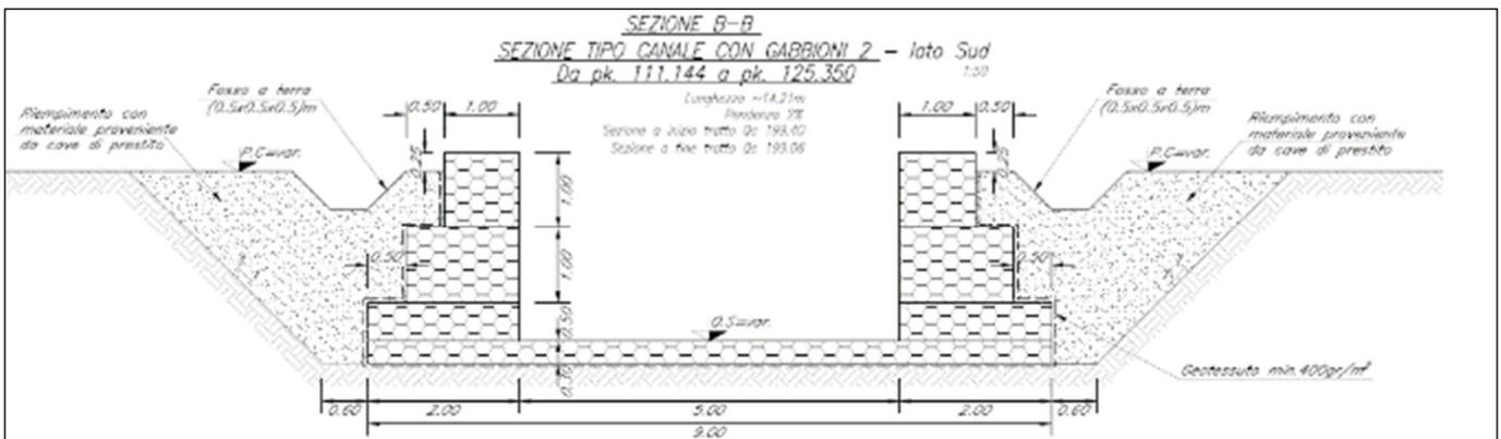
Figura 26 - Sezione di canale nel tratto a monte tra gabbioni
