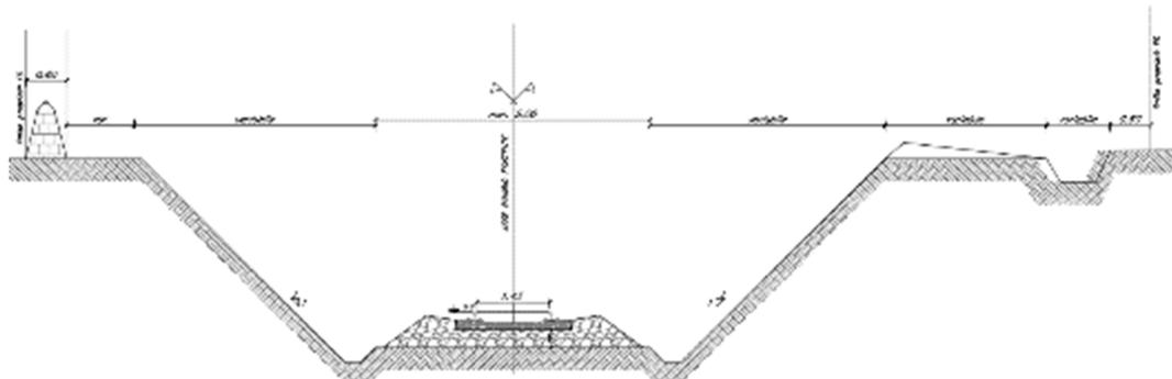
Figura 16 - Tratta Candela-Rocchetta – Sezione tipo esistente in rilevato singolo binario
