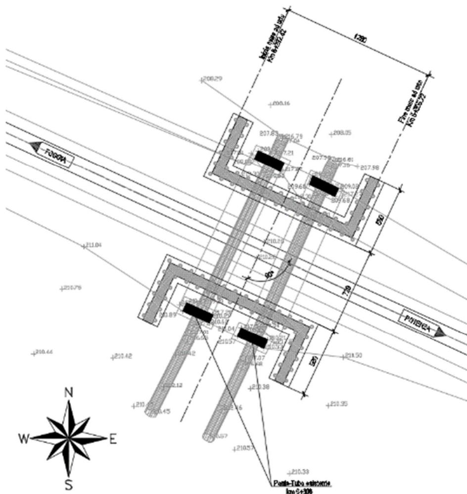
Figura 34 - Stralcio planimetrico dell'opera di protezione al km 6+300
