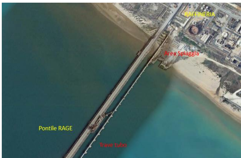
Figura 2-1– Collocazione strutture esistenti per shore approach Cassiopea
