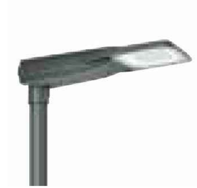
DgStreet Mini BGP761: corpo in alluminio, canopy verniciato colore grigio, vetro piano trasparente, classe II, completo di SPD, con attacco palo-testa palo.
