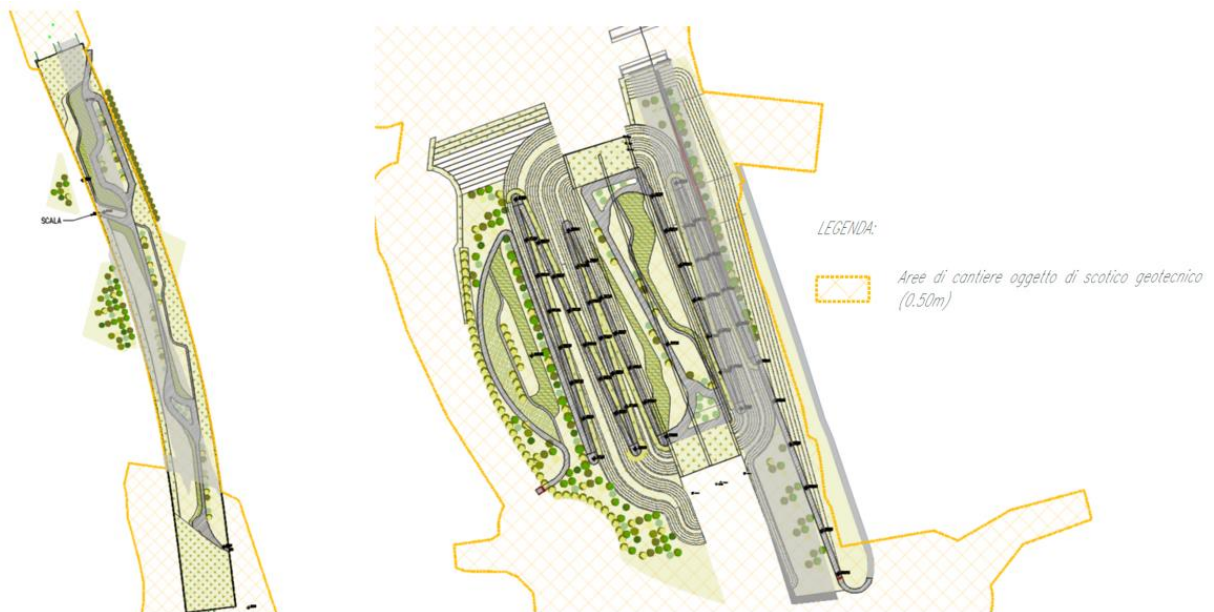
Figura 7 – Gallerie artificiali di Seveso (a sinistra) e Baruccanetta (a destra) e area oggetto di lavorazioni di cantiere (scotico geotecnico per uno spessore pari a circa 50cm).
