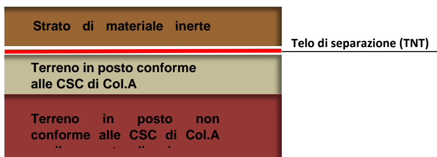
Figura 13 - Tipologico intervento di capping
