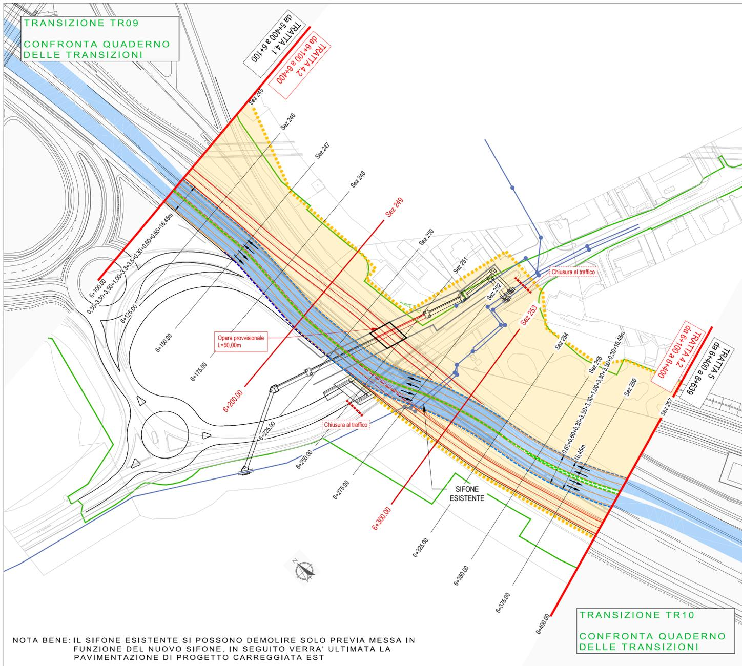
NOTA BENE: IL SIFONE ESISTENTE SI POSSONO DEMOLIRE SOLO PREVIA MESSA IN FUNZIONE DEL NUOVO SIFONE, IN SEGUITO VERRA' ULTIMATA LA PAVIMENTAZIONE DI PROGETTO CARREGGIATA EST
