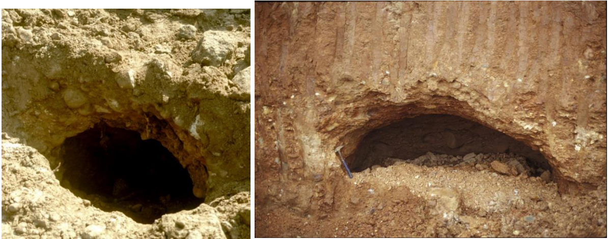
Figura 23 - Esempio di cavità rinvenuta durante gli scavi in un cantiere presso Novedrate, a sx; a dx sezione di un occhio pollino presso Bernareggio formatosi in ghiaie alterate; si notano alcune caratteristiche tipiche quali la volta emisferica e il materiale di crollo alla base (fonte: dott.Andrea Strini)
