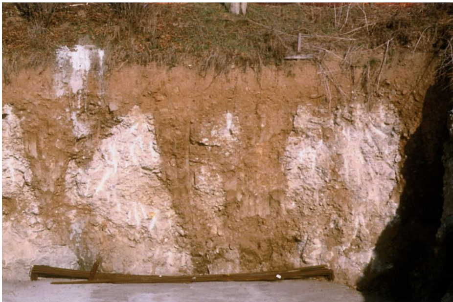
Figura 27 - Esempio di conglomerato a organi geologici; si nota il profilo estremamente irregolare del tetto del conglomerato dovuto al fronte di alterazione che ha una geometria irregolare. (fonte: dott.Andrea Strini)
