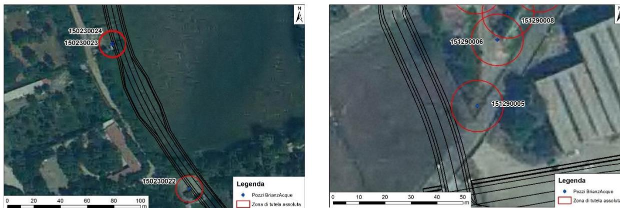
Figura 42 - Ubicazione dei pozzi con interferenza tra la Zona di Tutela Assoluta e il previsto tracciato dell'opera viaria, in comune di Biassono (a sx interferenza con la TRMI10) e Macherio (a dx interferenza con una viabilità secondaria prossima alla g.a. Macherio 3)
