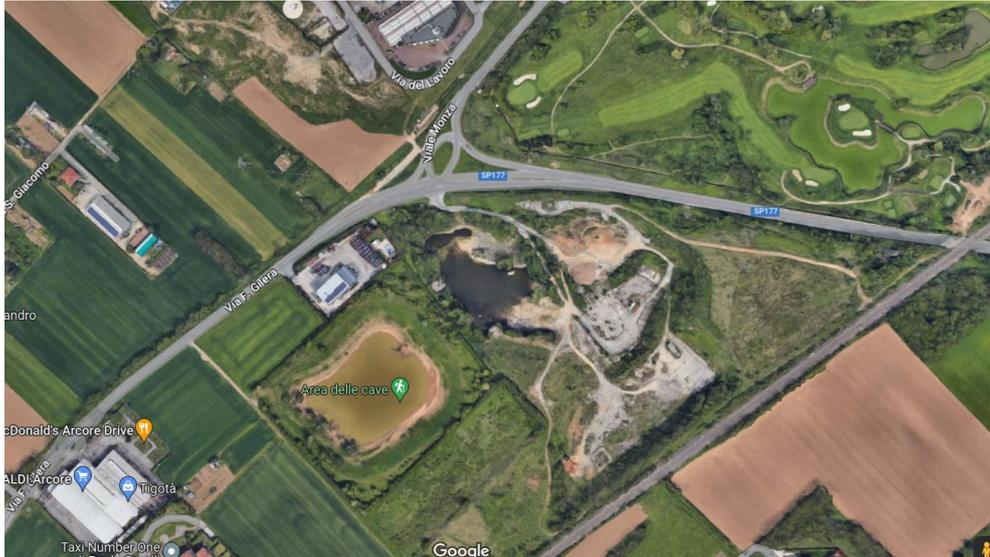
Figura 35 – Immagine aerea dell'ex-cava di Arcore posta nelle vicinanze del tracciato autostradale previsto. Si osserva l'affioramento della falda sul fondo dei settori scavati.
