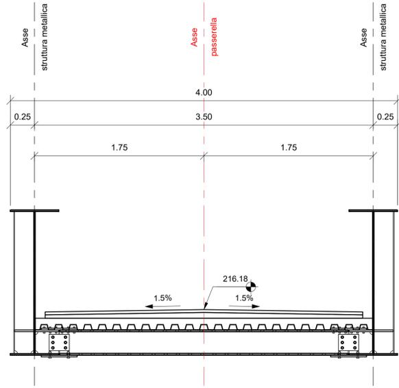
3 Sezione in asse appoggi pila P1
