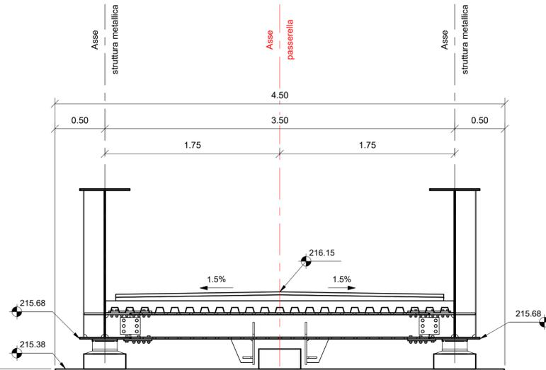
2 Sezione in asse appoggio spalla S2
