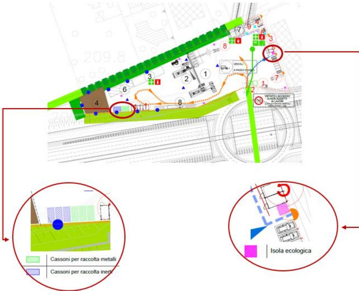
Figura 15 Cantiere operativo C.O2.1\_Ubicazione depositi temporanei
