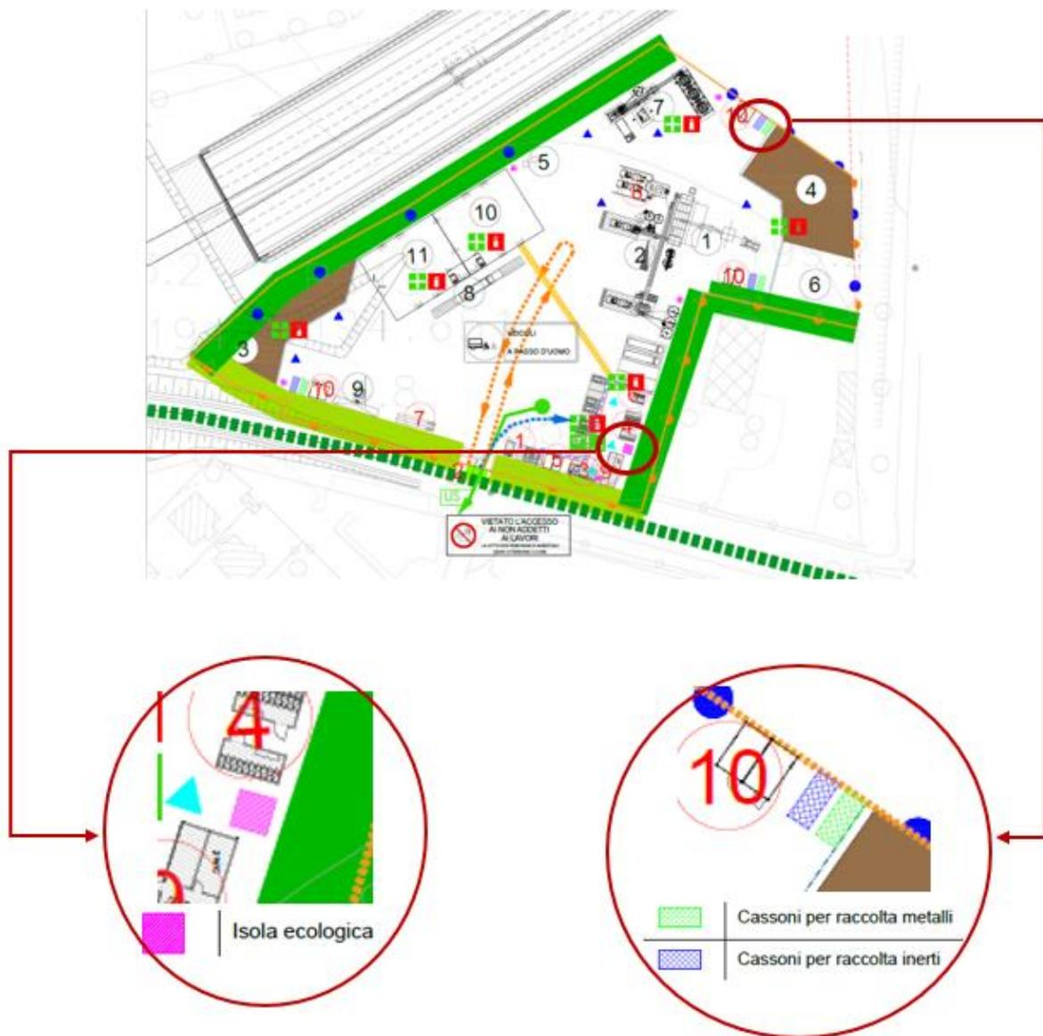
Figura 17 Cantiere operativo C.03.1\_Ubicazione depositi temporanei
