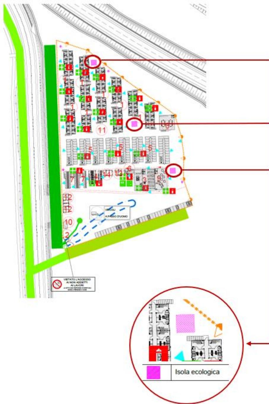
Figura 11 Cantiere base C.B2\_Ubicazione depositi temporanei
