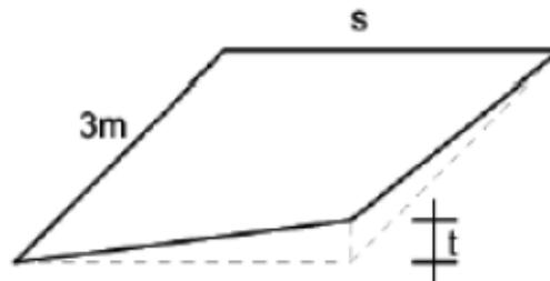
Fig. 5.2.14 - Sghembo ammissibile
