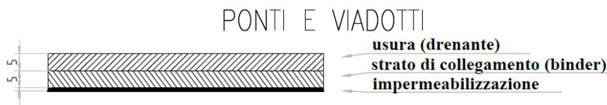
Figura 2 - Pavimentazione asse autostradale da Progetto Definitivo – ponti e viadotti
