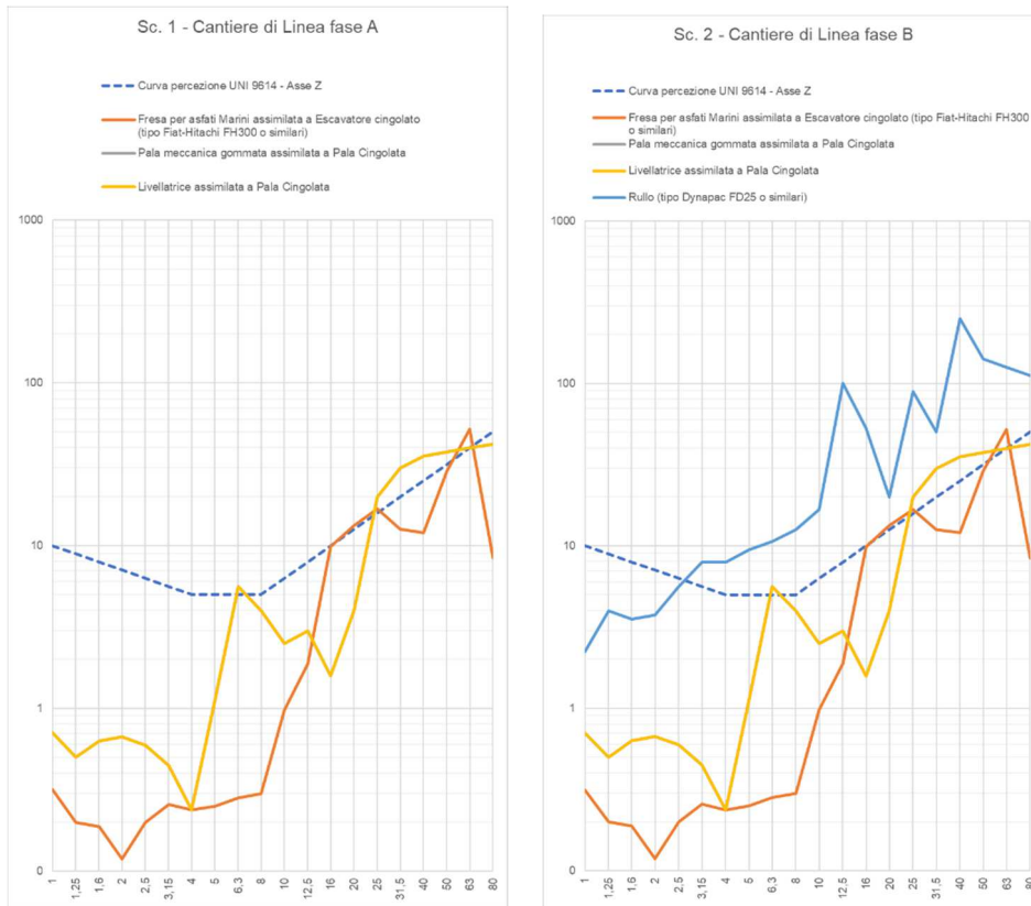
Figura 8-7 - Spettri delle sorgenti dei macchinari con confronto con curva di percezione della UNI 9614 per l'asse Z – Scenari 1 e 2
