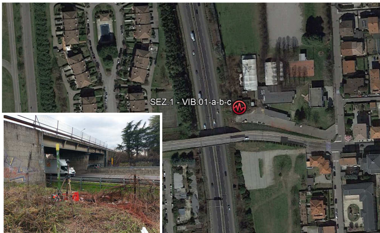
Figura 6-5 Planimetria della postazione di installazione della strumentazione di misura per la caratterizzazione del rilevato (nel riquadro il dettaglio del transetto SEZ.1-VIB.01-a-b-c)
