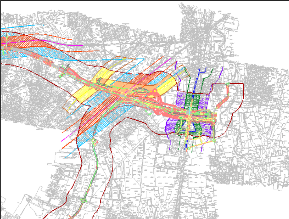
Figura 6 – Sovrapposizione fasce concorsuali di ferrovia Seregno-Bergamo, corso Italia (tipo Db), ferrovia Milano-Lecco e Autostrada A51 (tipo A) con fascia di pertinenza della tratta C.
