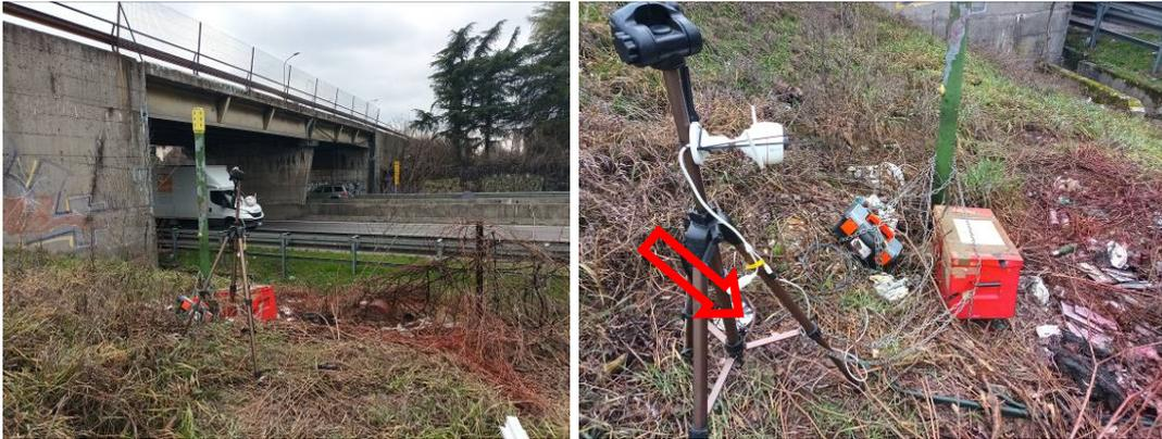
Postazione di installazione strumentazione di misura, transetto di misura (a sinistra), particolare della postazione indagata (a destra)
