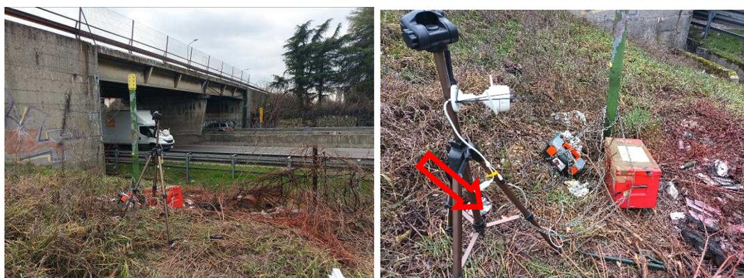
Figura 3-1 Postazione di installazione strumentazione di misura, transetto di misura (a sinistra), particolare della postazione indagata (a destra)
