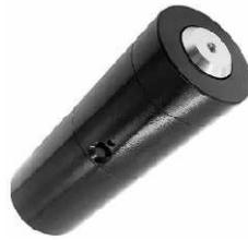
La calibrazione della strumentazione è effettuata tramite calibratore di vibrazioni mod. VC 01. Il calibratore delle vibrazioni produce un livello di accelerazione di 1g ( $9.81\text{m/s}^2$ ), velocità 9.81 mm/s, spostamento 9.81 micrometri alla frequenza di 159.2 Hz.
