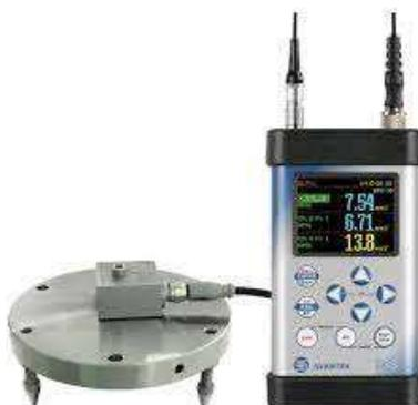
Gli analizzatori di vibrazioni Svan 958A sono strumenti completamente digitali, a 4 canali e di classe 1, i quali hanno le seguenti principali caratteristiche:
