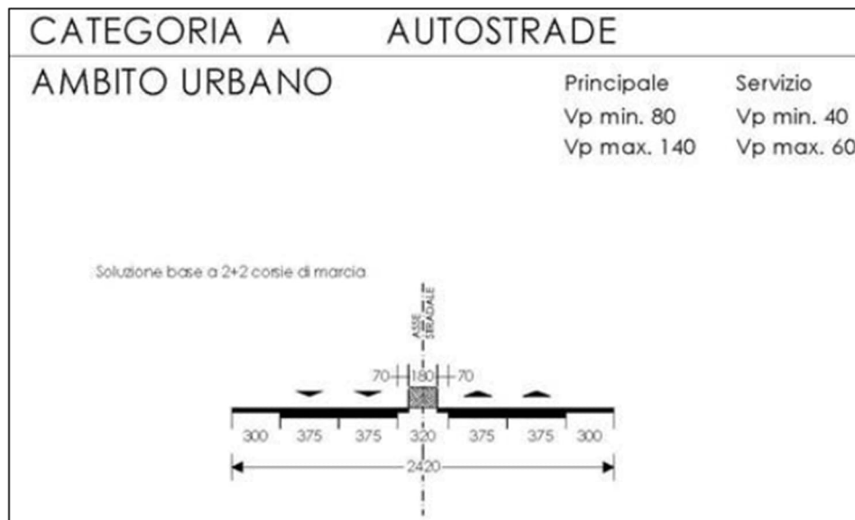
Figura 2-2 - Dimensione dell'asse autostradale subtratta Lentate sul Seveso
