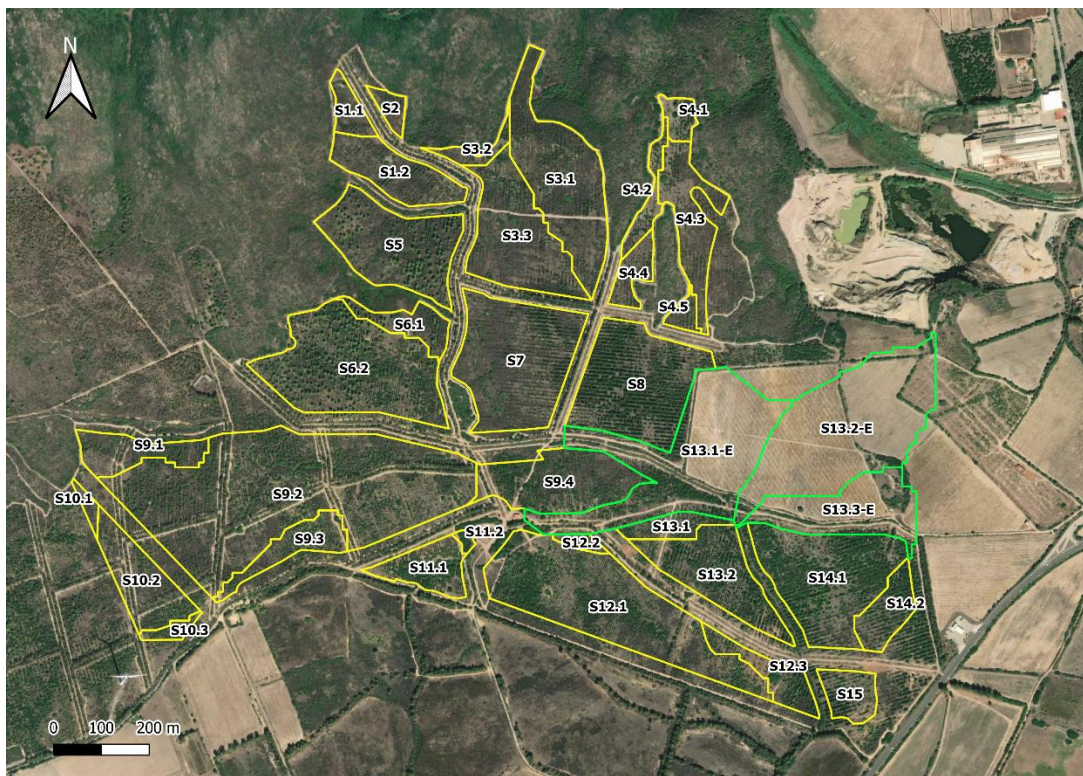
Figura 8.6: Delimitazione bacini scolanti dell'area di progetto e relativa codifica. In giallo i bacini interni, in verde quelli esterni.
