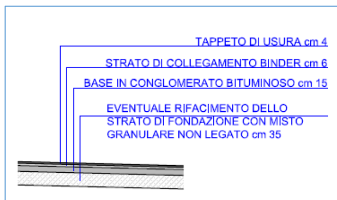
Figura 21 – Pacchetto stradale di progetto
