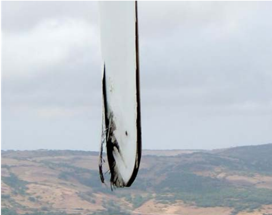
Figura 3: Estremità di pala danneggiata da fulminazione atmosferica
