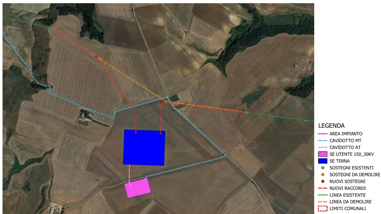
Figura 3-3: Inquadramento delle opere di connessione su ortofoto
