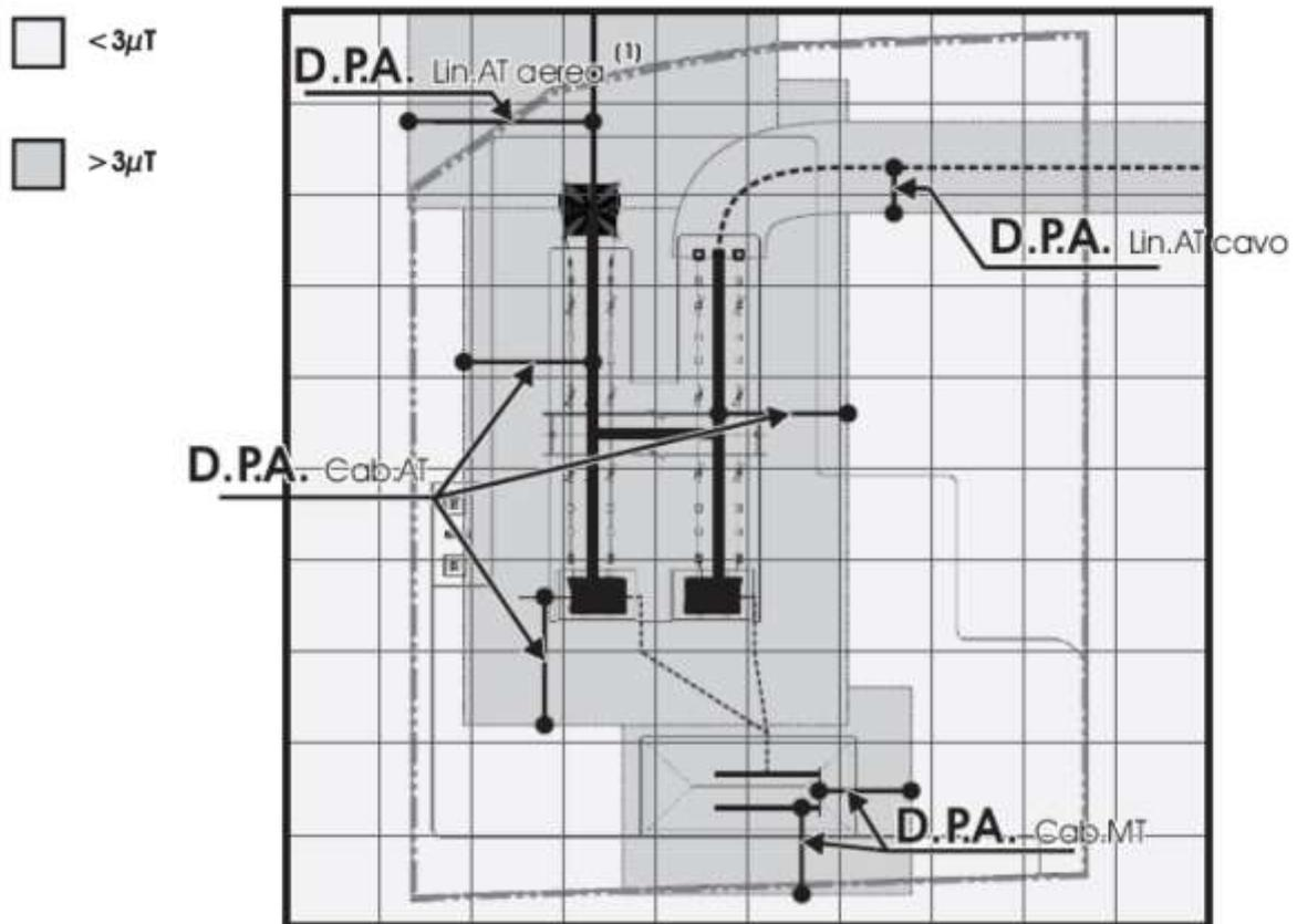
Figura 1: Determinazione della DPA per una Cabina Primaria isolata in aria a 132 kV
