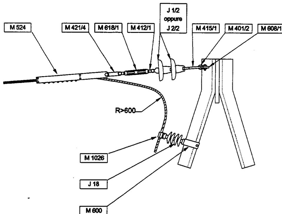
Nota Le quantità dei morsetti unifilari M 1026, degli isolatori J 18 e delle staffe di fissaggio M 600 per la discesa della fune di guardia alla scatola di giunzione devono essere specificate in funzione del tipo ed altezza del sostegno sul quale viene realizzata la discesa isolata.
