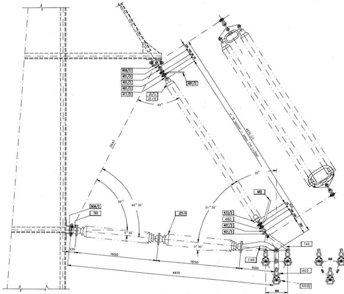
VISTA LATERALE ATTACCO CONDUTTORE INFERIORE
