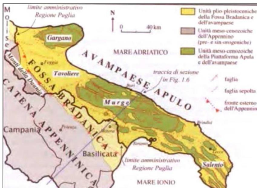
Figura 4: Unità strutturali
