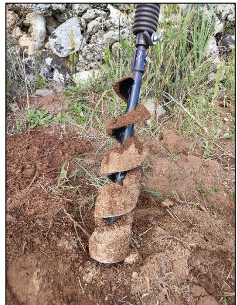
**Fig.21** – Affioramento in superficie delle Calcareniti e dettaglio del terreno vegetale escavato con la mototrivella
