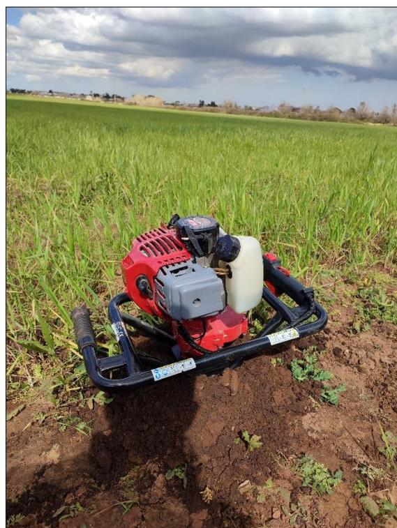
**Fig. 16** – Scavo con mototrivella.
