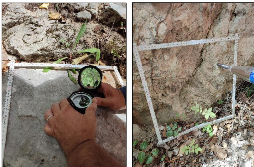
Fig. 03 – Fasi dal rilievo geomeccanico
