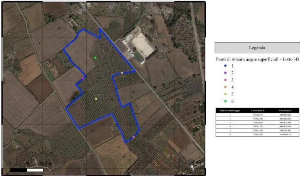
Figura 51: Punti di installazione piezometri – lotto 3B
