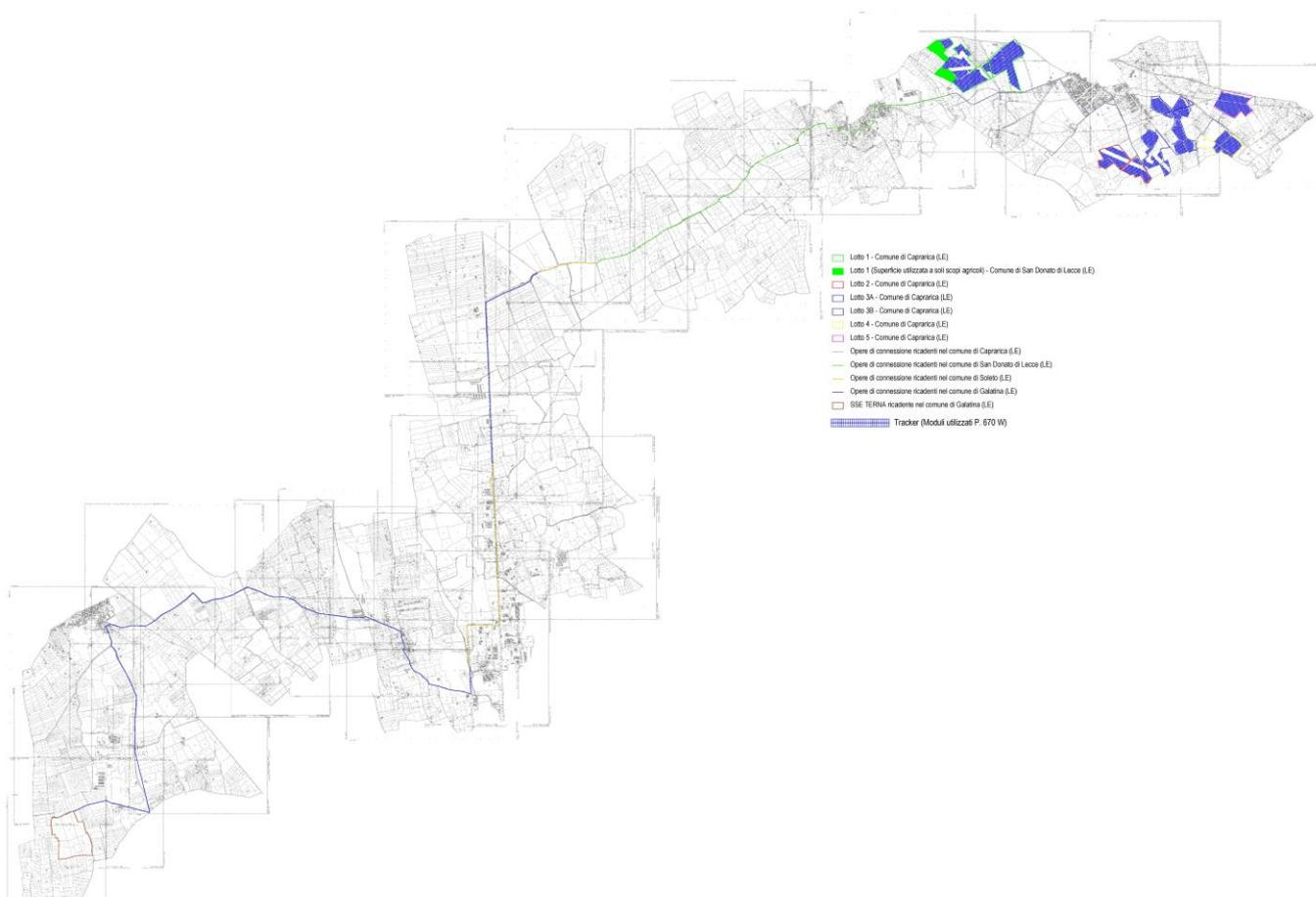
*Figura 5: Percorso del cavidotto di collegamento cabina di raccolta con cabina di trasformazione AT – Terna (GALATINA – LE)*
