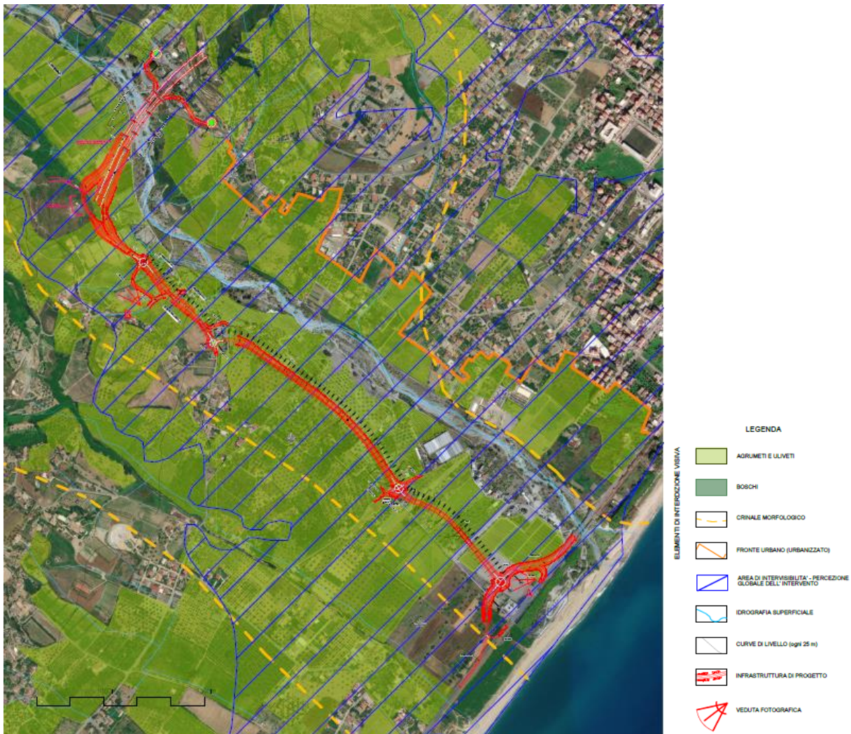
Fig. 1 Estratto dalla Carta della morfologia del paesaggio e della percezione visiva Planimetria del paesaggio di inserimento della nuova infrastruttura (in rosso), in blu campito l'area di intervisibilità del progetto, in giallo i crinali, in verde Agrumeti e Uliveti e in rosso i coni di ripresa fotografica.
