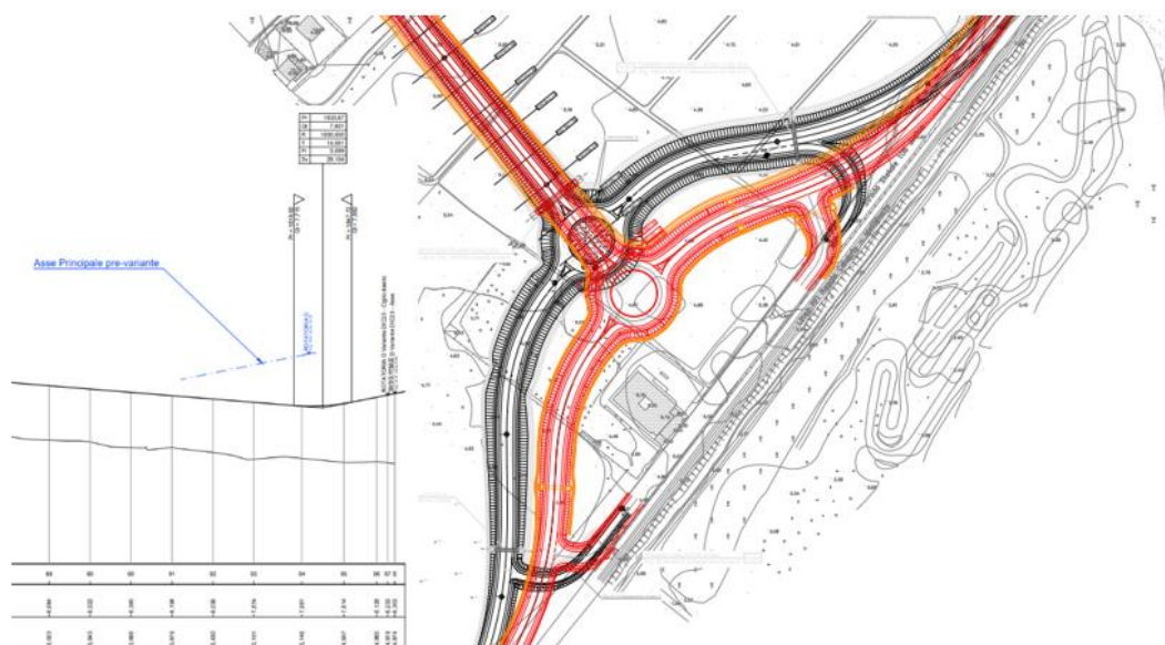
Fig. 8 In rosso il tracciato ottimizzato. Di lato, a sinistra, in blu la livelletta antecedente l'ottimizzazione
